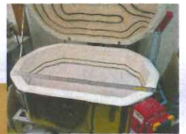
GTS2541キルンに Vボードを入れた例
