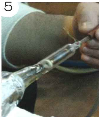
5 電極にはソーダガラス用とポロシリケート用があるので注意。
