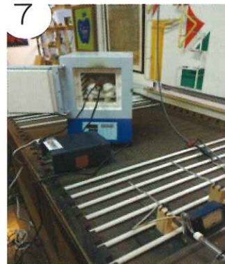
7 電気炉で作品を280℃まで加熱し、作品内の空気を真空装置で抜いていく。
