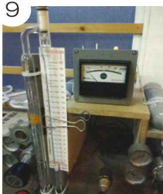
9 全ての空気と発生するガスが抜けたら種類によって発色の異なるガス（アルゴン、ネオン、キセノン、ヘリウムなど）を微量注入する。
