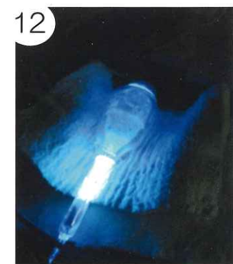
12 作品が冷めた後、再度トランスに繋ぎ、一晩エージングを行って完成。
