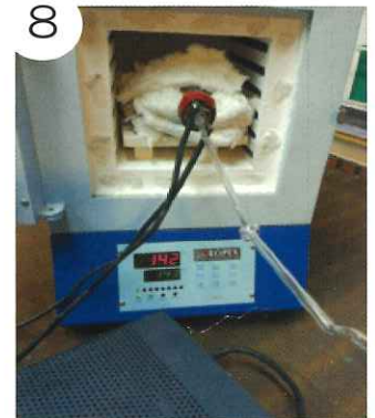
8 内部が真空になったらインダクションヒーターで電極の金属を焼き、発生するガスを排気する。
