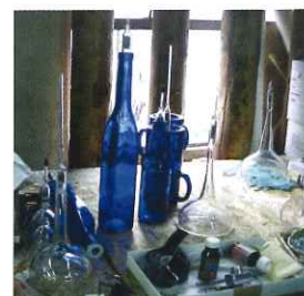
11 自分好みの発光が得られたら、作品を繋いでいるガラス管を溶断して取り外す。
