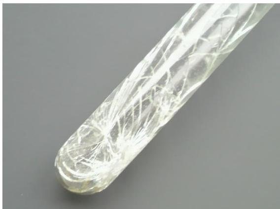
塗布した試験管は割れても飛散しません
