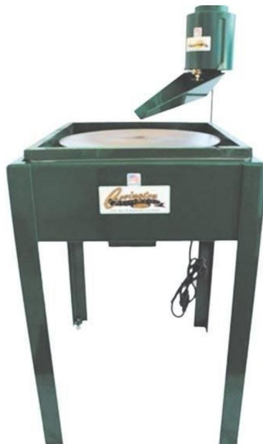
この製品は、金剛砂と水を使用して研磨を行うための機械です。
