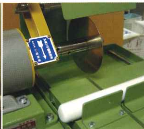
別売のスライド式カッティ ングテーブル (55x34cm) をセットすればガラスの 塊やロッド、厚板等が 素早くカット出来ます。
