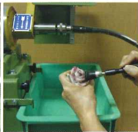
フレキシブルシャフトを 使えば凹凸の有る細かな 作品の研磨に便利！ (長さ150cm, φ3mm, 6mmのコレクト チャック付)
