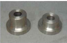
アルミフランジ 左：平盤/ポンテ リムーバー用 右：ダイヤモンド用
