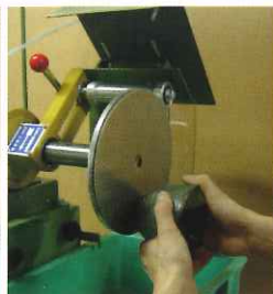
別売のアルミ製8” ディスクを装着後、 マグネット付ダイヤ 盤を取り付け縦型 平盤に。
