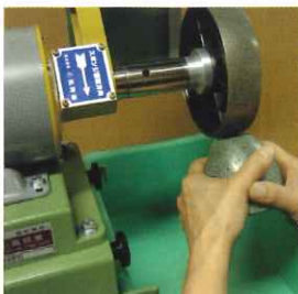
チャックシャフトを 追加すれば、軸径 φ10mmまでの 色々な研磨ビットが 使用できます。
